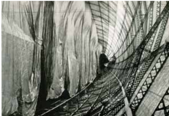
Entramado de cables y acero de la estructura de aluminio de un zepelín en cuyo interior, generalmente a la luz de una linterna, se movía la tripulación. Fuente: Colección CLA
