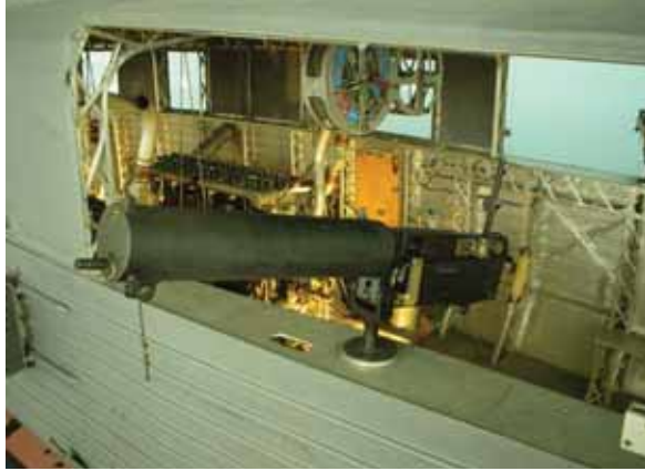
Puesto defensivo de la cabina de mando de un zepelín equipado con ametralladoras pesadas MG 08 de 7,92 con una cadencia de cuatrocientos cincuenta disparos por minuto. Fuente: A. Pérez
